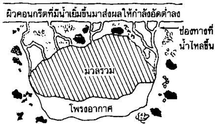
รูปที่ 4 คอนกรีตอัดแน่นในท่อ เทเนื่องจากคอนกรีตเกิดการผันแปรจากการเข้มน้ำ
